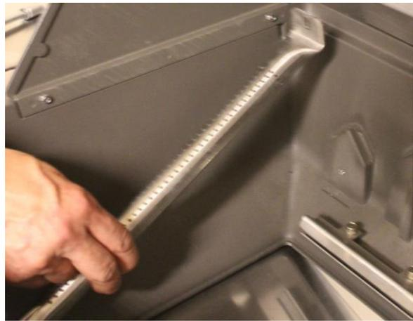
3 Die Luftzufuhrklappe öffnen und die Öffnung vergrößern/verkleinern.
